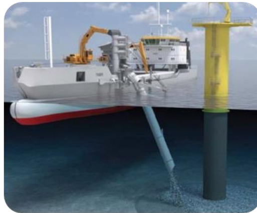
圖5.17-2 落管式拋石船示意圖
