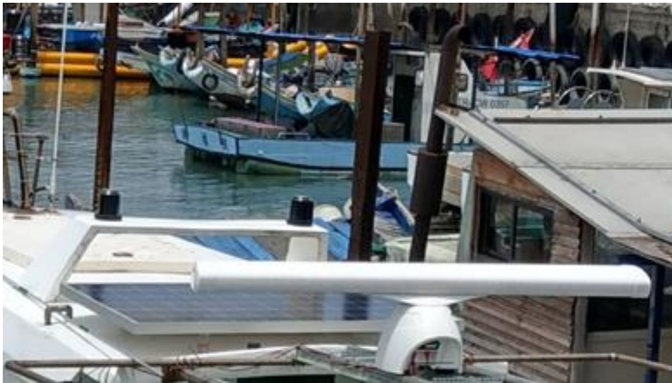
圖 1.4-4 架設於船舶上之雷達天線
