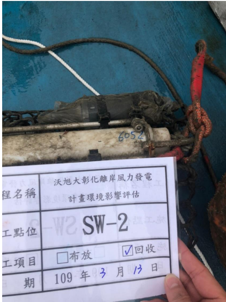
圖 2.5-5 水下噪音儀器 SW-2 現場回收
