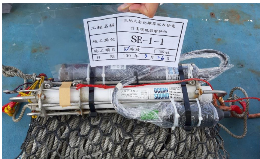
圖 2.5-6 水下噪音儀器 SE-1-1 現場補佈放
