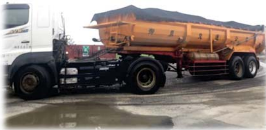
運送土方車輛覆蓋防塵網
